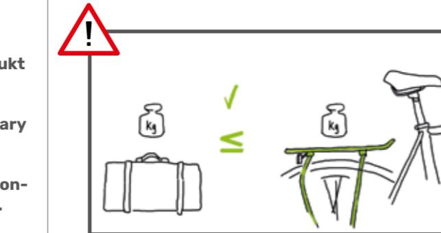
Max. Zuladung | Max. load | Charge max. | Max. belastning | Carga máx. | Carico max.
